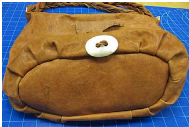
Sivukappaleet ryppytetään symmetrisesti pohjaan ommeltaessa.
