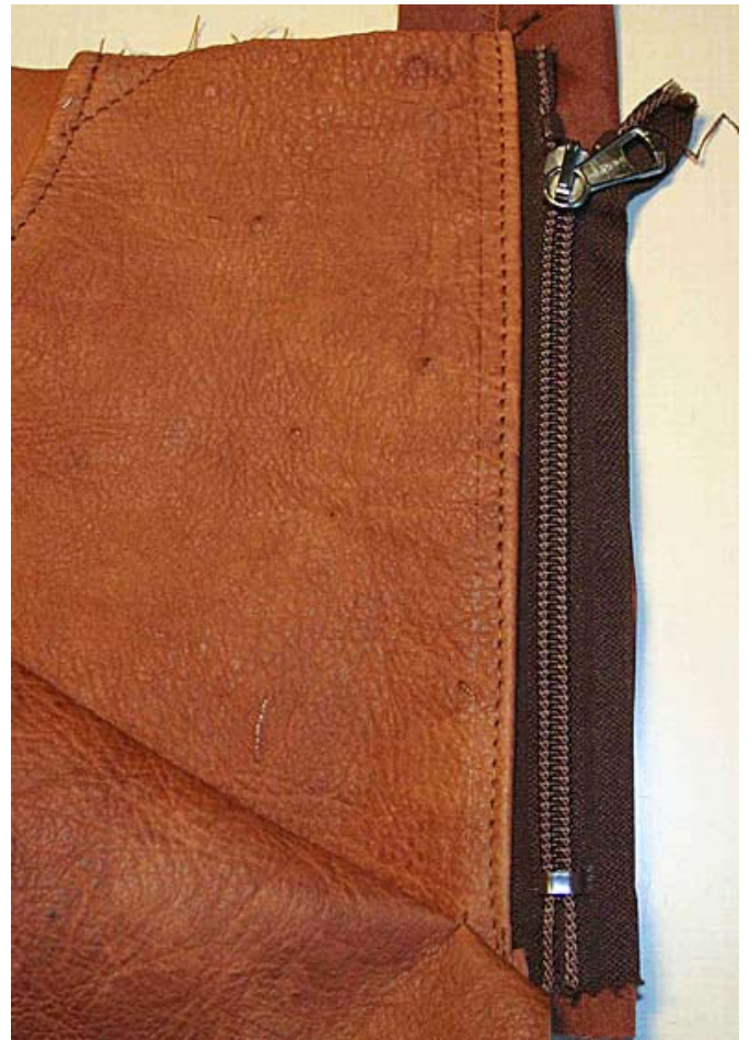
Tikatessa kiinnitetään alle vetoketjukaitale.
