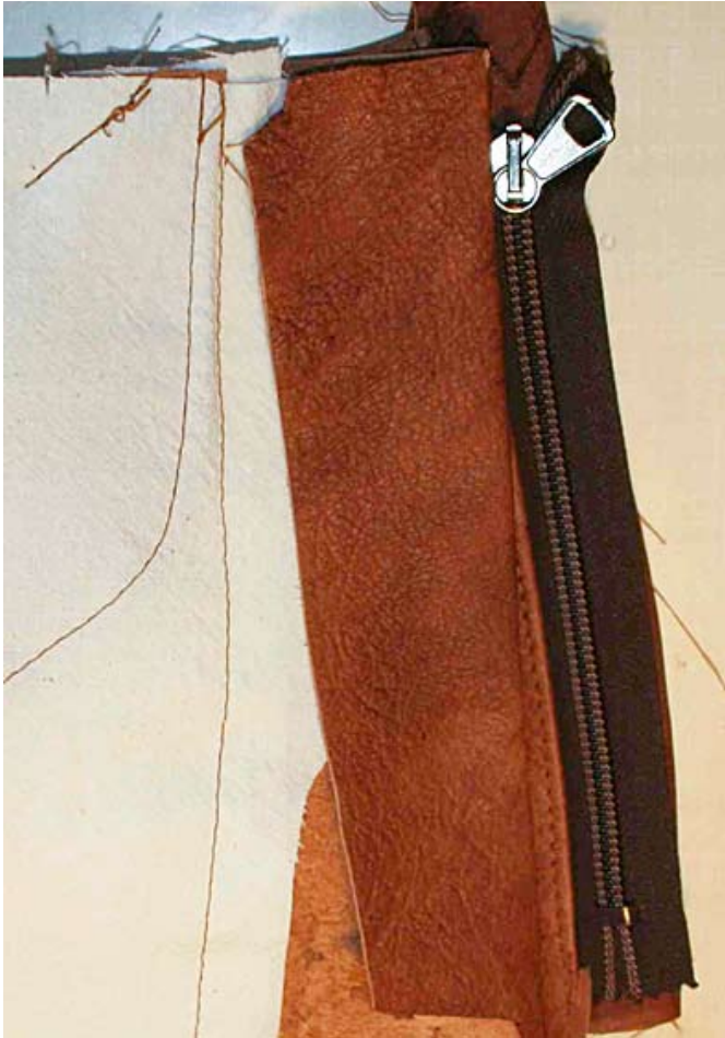
Vetoketjuvara taitetaan ja liimataan.
