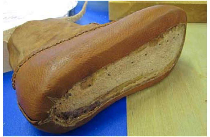
Naulat irrotettu ja pinkovararit leikattu siistiksi pohjan täyttöä varten.
