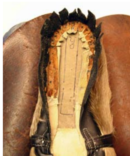
Vuori ja päällisen pinkovara liimataan pinkopohjaan ja toisiinsa. Pinkopohjaan liimataan myös metallivahvike.
