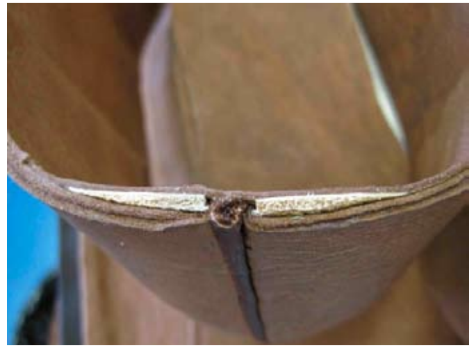
Lähikuva saumasta. Ylhäältä: kantakappi, rantinauhat, vuorinahka, päällinen eli pintanahka. Saumassa tere.
