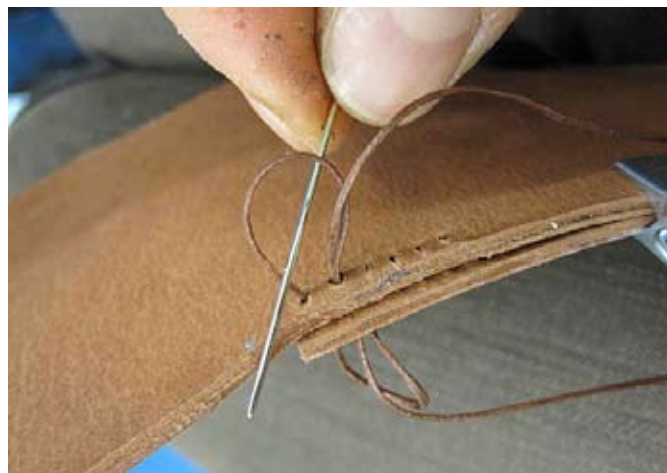
Jokaisen tikin jälkeen tehdään ”solmu” joka kiristetään sauman sisään.
