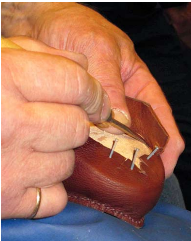
Nahkaa vedettäessä on varottava ettei sisäpohja käänny kaksinkerroin.
