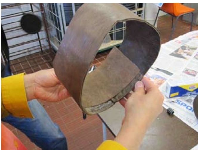
Kantakappi liimattu kantapääsauman päälle.
